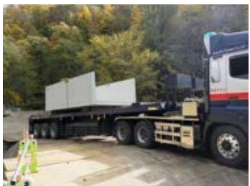
写真 3.1.5 セミトレーラー運搬
